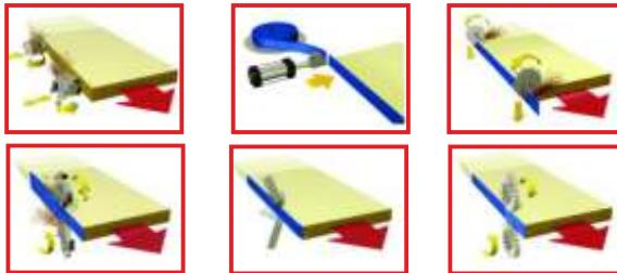
Предназначен для облицовывания прямолинейных кромок мебельных щитов и заготовок натуральным полосовым или синтетическим рулонным материалом типа меламин, АБС, ПВХ, шпон, пластик и акрил толщиной до 3 мм.
