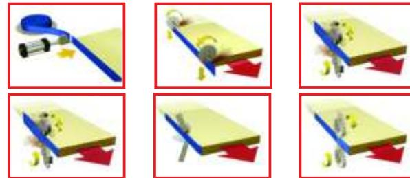
Предназначен для облицовывания прямолинейных кромок мебельных щитов и заготовок натуральным полосовым или синтетическим рулонным материалом типа меламин, АБС, ПВХ, шпон, пластик и акрил толщиной до 3 мм.
